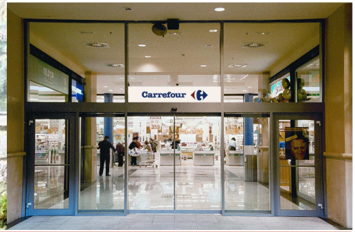
İki Hareketli İki Sabit Kanatlı Yana Kayar Fotoselli Kapılar
