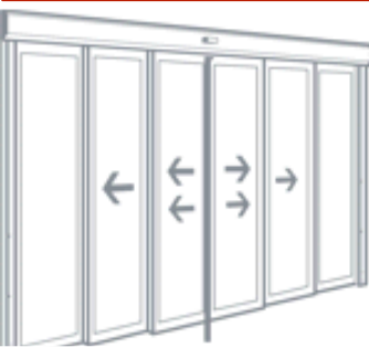
Dört Hareketli İki Sabit Kanatlı Teleskopik Yana Kayar Fotoselli Kapılar – Geniş Açıklıklar İçin
